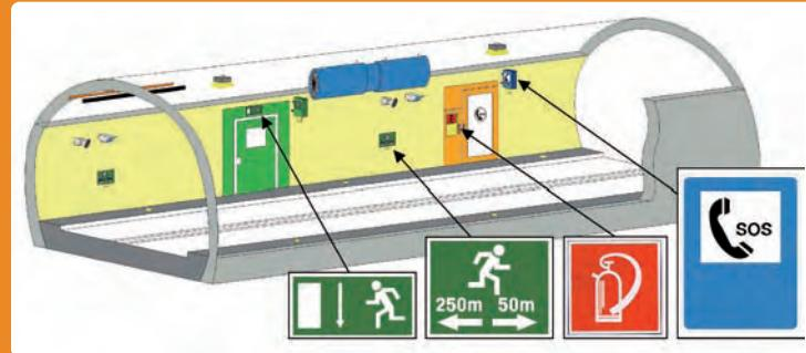
Alle 150 m befinden sich Notrufstationen. Von hier aus wird man direkt mit der Tunnelzentrale verbunden, von wo aus alle erforderlichen Maßnahmen eingeleitet werden. Eine Handybenutzung erschwert die Standortbestimmung und verzögert gefahrenabwendende Maßnahmen. Die Notrufstationen sind mit Feuerlöschern und Feuermeldern ausgestattet. Alle 300 m sind Notausgänge angeordnet, die in sichere Bereiche führen. Spezielle Fluchtwegkennzeichnungen weisen den Weg zum nächsten Notausgang.
